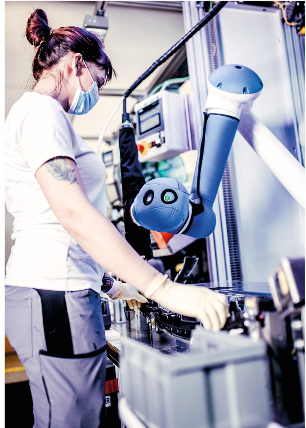
Abb. 4: COBOTs, also kollaborierende Roboter, arbeiten gemeinsam mit den Montagemitarbeitern am Fertigungsband. © ZKW
